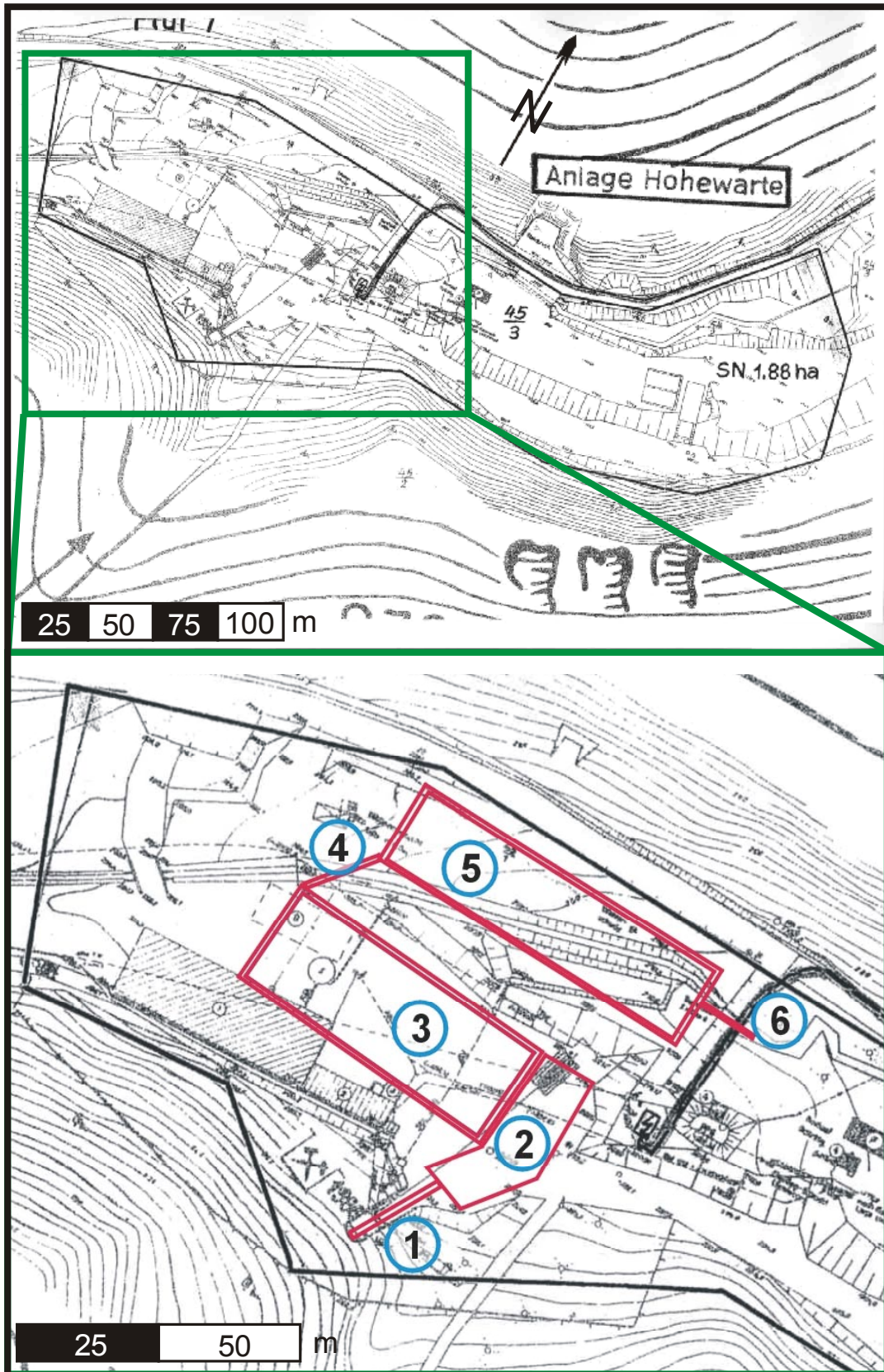
Abb. 43: Schematische Darstellung des Entwurfs der Behandlungsanlage 1 Austritt des Grubenwassers, 2 Auffangbecken, 3 RAPS-System, 4 Kaskade, 5 aerobes Feuchtgebiet, 6 Einleitung in den Steinbach
