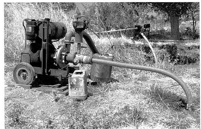
Abb. 6 Charakteristische Pumpe am landwirtschaftlich genutzten Bohrloch BOC am südlichen Ortsrand von Çıplak.
