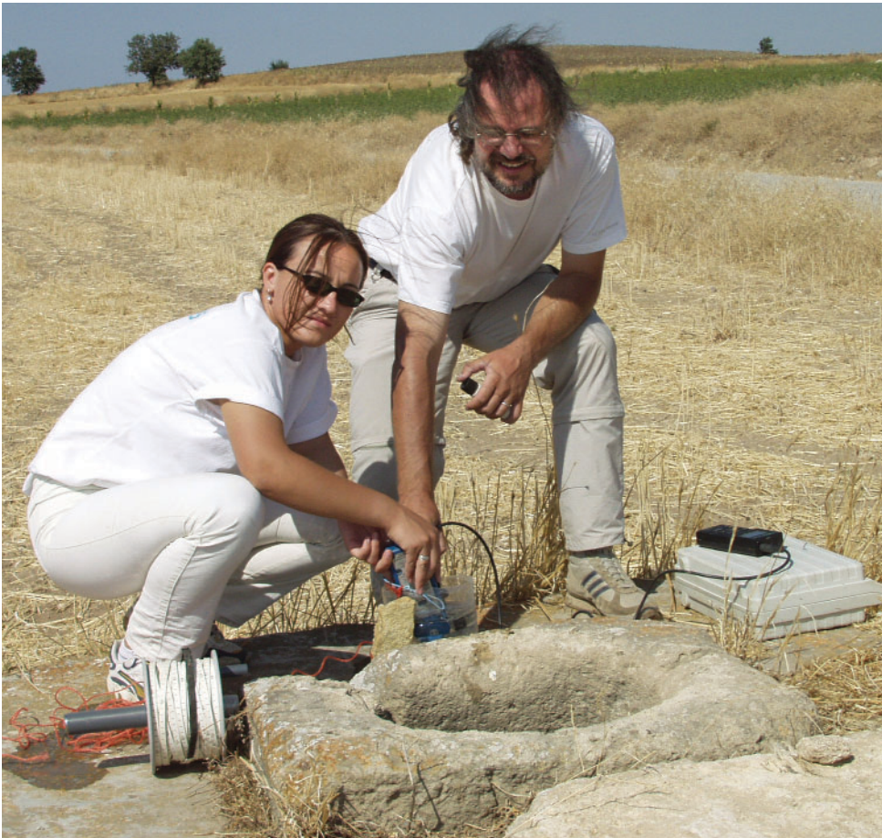
▼ Abb. 1 Probenahme an einem Schachtbrunnen. Links das Kabellichtlot zum Messen der Wasser- und Brunnentiefe, in der Mitte Wasserbehälter zum Messen der physikochemischen Parameter, rechts auf dem Koffer die Anzeigeeinheit für den Sauerstoffgehalt.
