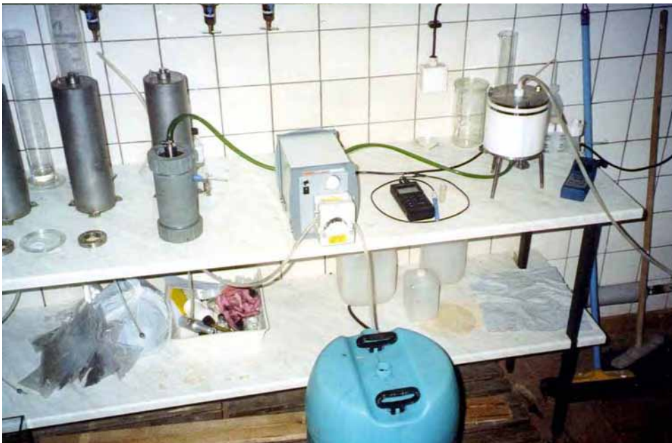
Abb.39: Versuchsaufbau des kombinierten Versuches mit Kalkstein und Kompost (Durchfluss 0,2 L/min)
