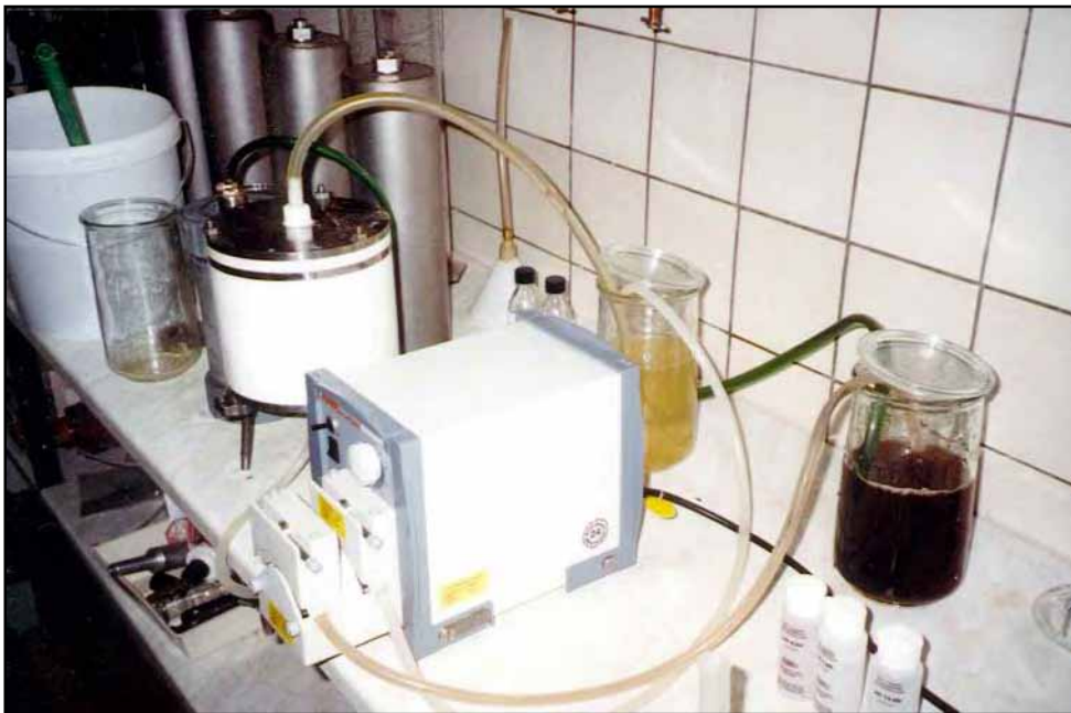
Abb.38: Versuchsaufbau des Kreisversuches mit 0,2 L/min
